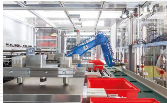
Jede einzelne Sicherheitseinrichtung und Schlauchkupplung wird einer Prüfung in einer Helium-Vakuum-Dichtungsprüfanlage unterzogen.
